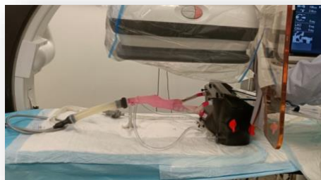
Figure 1. Simulation d'une EVAR sur un modèle d'anévrisme de l'aorte abdominale en salle de chirurgie (Hôpital Marie Lannelongue)
