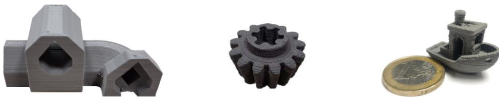
Figure 2. Exemples de pièces vertes imprimées par MEAM granulés
